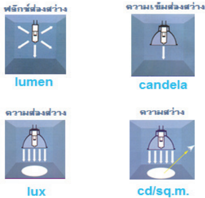
รูปที่ 3.28 แสดงการเปรียบเทียบ ค่าจำกัดความดันแสงสว่าง
