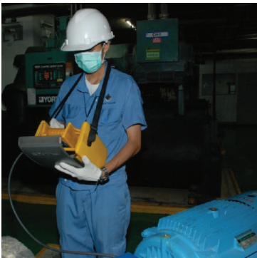
รูปที่ 3.58 แสดงการวัดค่าความสั่นสะเทือน รูปที่ 3.59 แสดงมาตรฐานการวัดค่าความสั่นสะเทือน
