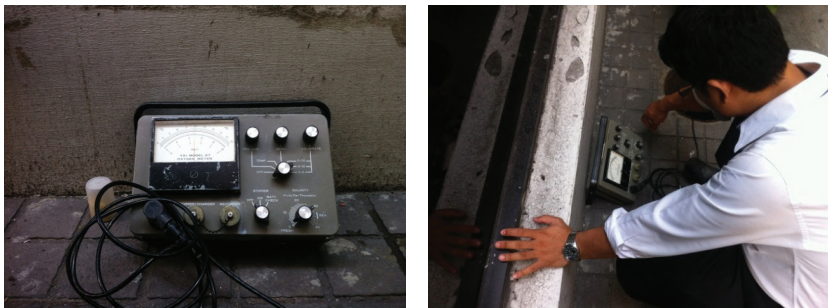
รูปที่ 3.43 เครื่องวัดค่า DO และการวัดค่าออกซิเจนละลาย (DO) ในบ่อบำบัด
