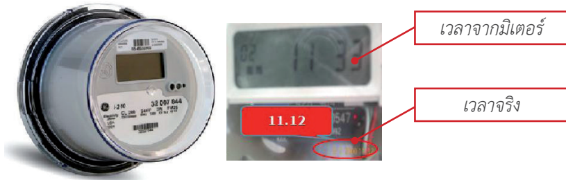
รูปที่ 3.8 แสดงเวลาที่คลาดเคลื่อนของมิเตอร์การไฟฟ้า
